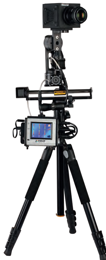
Высокоскоростная камера EVERCAM на поворотной трехкоординатной платформе
